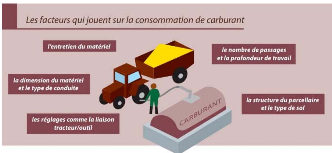
Figure 1 : Pistes pour maîtriser la consommation de carburant dans les tracteurs (Source : Chambre d'Agriculture de Picardie)
