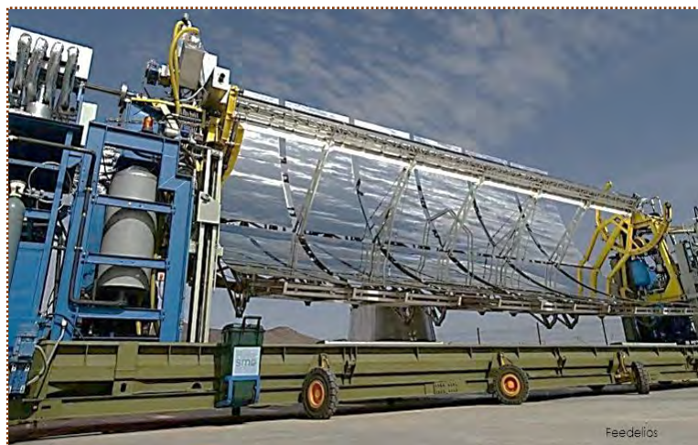
Le four solaire à micro-ondes (solar microwave oven, SMO) de taille industrielle pour la valorisation de la biomasse organique et des déchets organiques
