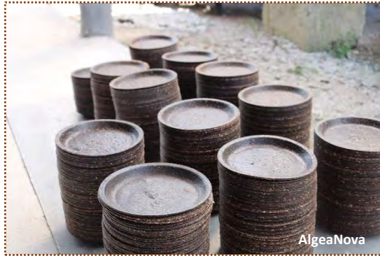
Assiettes à usage unique biodégradables, à base de sargasses et de manioc, fabriquées à Punta Cana
