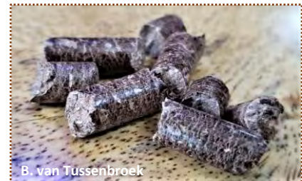
Bio-granulés à base de sargasses développés et testés au Mexique par Energryn
