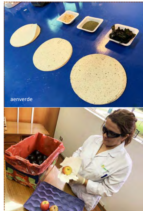
Papier à base d'algues pour la protection et la conservation des fruits pendant l'exportation, Université Concepción, Chili
